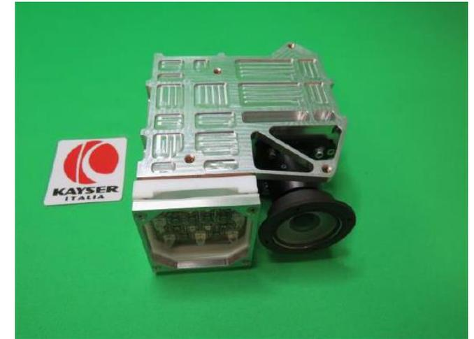
Блок визуализации PROSPECT с системой подсветки, разработанный Kayser
