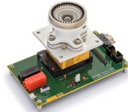
Одна из видеокамер MMX в сборе с механическим интерфейсом и объективом, установленная на отладочную плату оборудования EGSE
